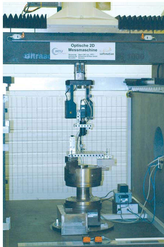
OpenCNC steuert die Kamera über drei Linear- und drei Drehachsen mit einer Genauigkeit von bis zu fünftausendstel Millimetern.
