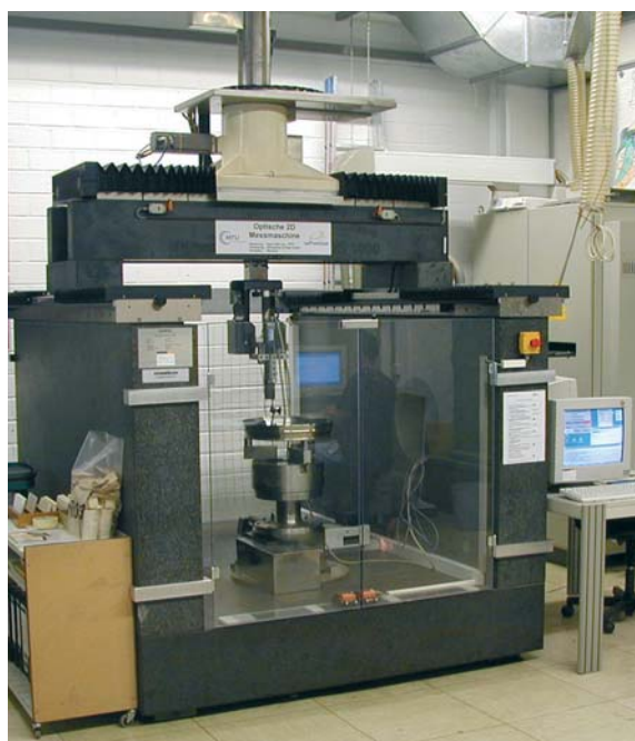
Retrofit: Von der hochauflösenden Ultraschallanlage zur optischen, mit OpenCNC gesteuerten 2D-Messmaschine.
