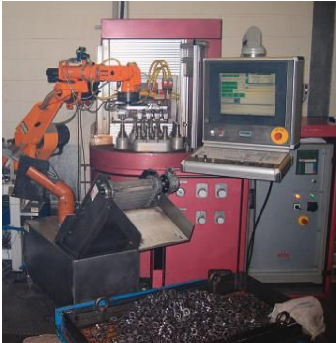
Abbildung: Dank Retrofit mit Open-CNC erzielen auch mehrere ältere Maschinen eine hohes Produktivitätsniveau. Mit der Software lassen sich auch die verschiedenen pneumatischen und
