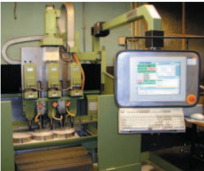
mierung der Softlogik, die Installation des Pentium PCs mit TFT-Touchscreen und der Umbau des Steuerungsschranks gingen zügig voran. Für einen Bediener, der bereits mit Windows vertraut ist, genügt eine zweistündige Einweisung an der Maschine, um die neue Steuerung bedienen zu können.
